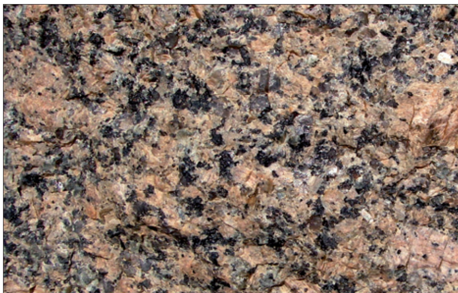
Joonis 15. Viiburgiitne rabakivigraniit, Marjuksenranta, Vehmaa. Värske kivimi pind ülal, murenenud pind all. Murenenud pinnal on kerge märgata põhilisi koostismineraale. Kivim sisaldab rabakivigraniitidele tüüpilist plagioklassiga ümbritsetud kaalium-päevakivi ümaraid ovoid. Geoloogilisel kaardil on rabakivi tumelilla. Foto: O. Eklund
